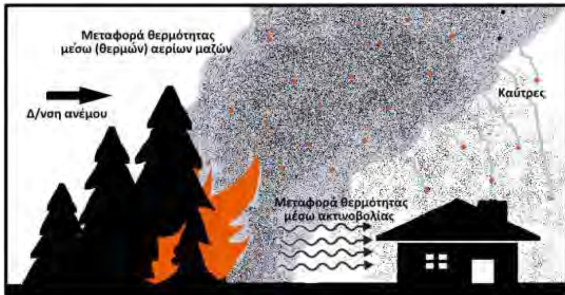
Σχέδιο 3. Τρόποι ροής της θερμότητας σε μια δασική πυρκαγιά, που εξελίσσεται πλησίον κτιρίου & απεικόνιση πιθανού τρόπου μετάδοσης δασικής πυρκαγιάς με μεταφερόμενες καύτρες σε κτίρια παρουσία μέτριου ανέμου.
