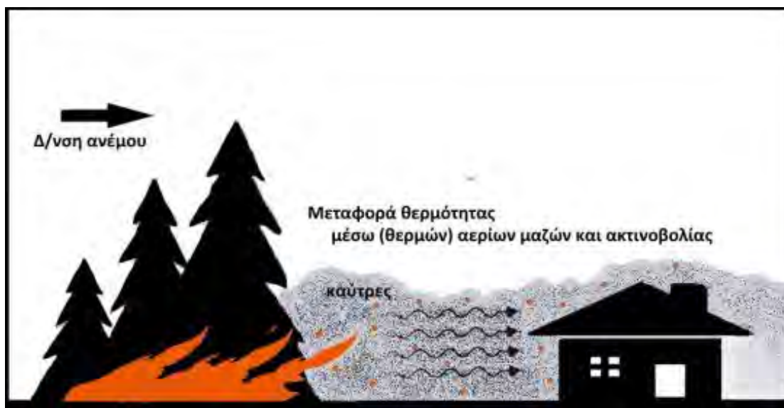
Σχέδιο 4. Τρόποι ροής της θερμότητας σε μια δασική πυρκαγιά, που εξελίσσεται πλησίον κτιρίου & απεικόνιση πιθανού τρόπου μετάδοσης δασικής πυρκαγιάς με μεταφερόμενες καύτρες σε κτίρια παρουσία ισχυρού ανέμου
