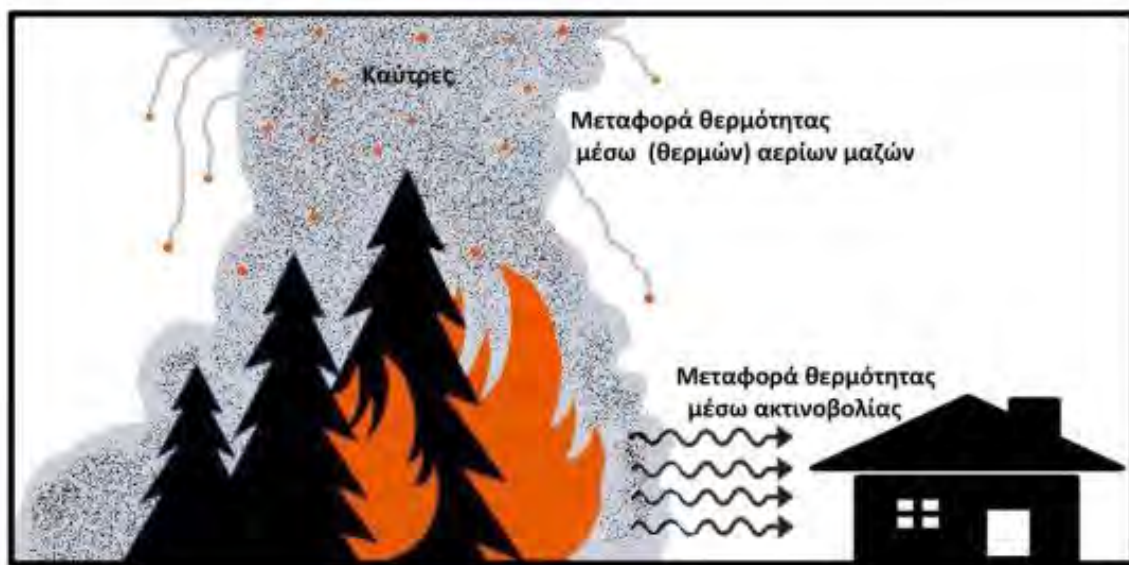
Σχέδιο 2. Τρόποι ροής της θερμότητας σε δασική πυρκαγιά, που εξελίσσεται πλησίον κτιρίου & απεικόνιση πιθανής μετάδοσης δασικής πυρκαγιάς με μεταφερόμενες καύτρες σε κτίρια χωρίς την παρουσία άνεμου σε συνθήκες πρόσκαιρης νηνεμίας, ή ατμοσφαιρικής ευστάθειας.
