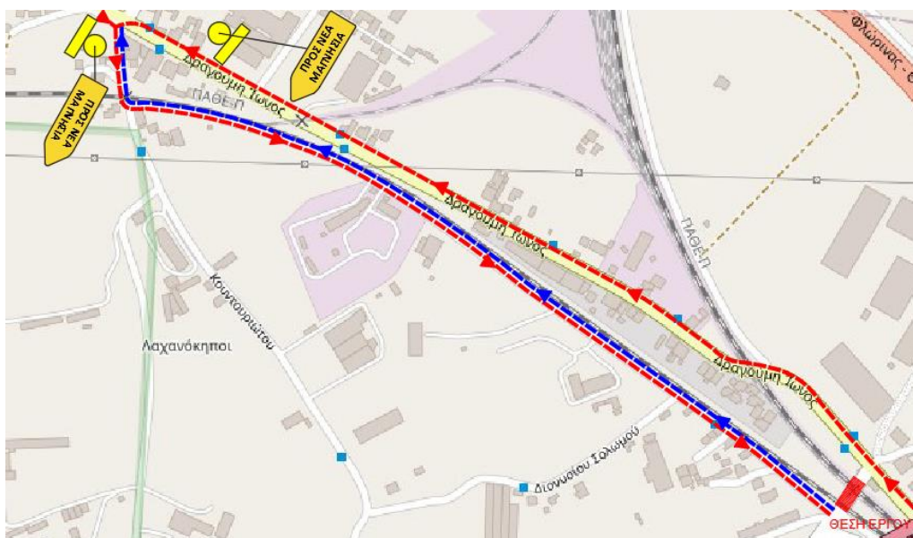
Εικόνα 5.1: Εκτροπή κυκλοφορίας στη Χ.Θ. 9+860
