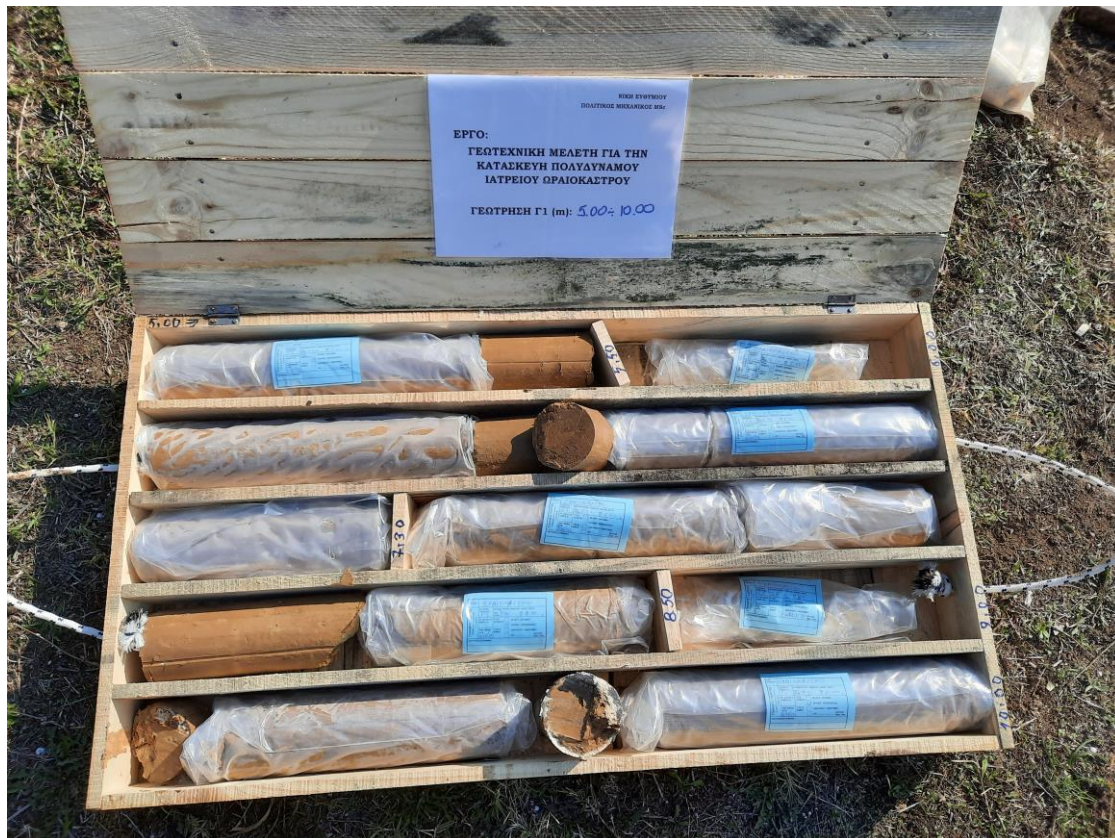
Φωτ. 4: Γεώτρηση Γ1 – Δείγματα Πυρηνοληψίας Εδάφους βάθους 5.0 – 10.00m
