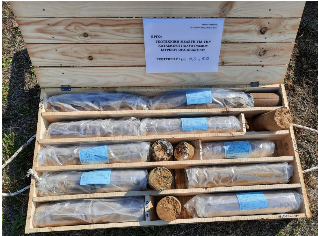
Φωτ. 3: Γεώτρηση Γ1 – Δείγματα Πυρηνοληψίας Εδάφους βάθους 0.0 – 5.00m
