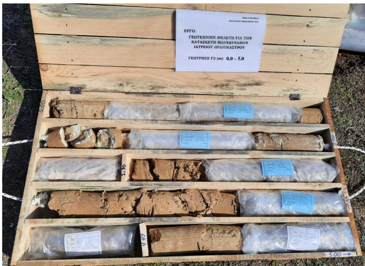
Φωτ. 5: Γεώτρηση Γ2 – Δείγματα Πυρηνοληψίας Εδάφους βάθους 0.0 – 5.00m
