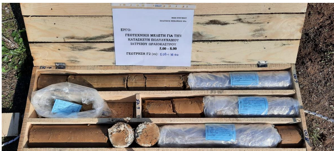
Φωτ. 7: Γεώτρηση Γ2 – Δείγματα Πυρηνοληψίας Εδάφους βάθους 5.0 – 8.00m
