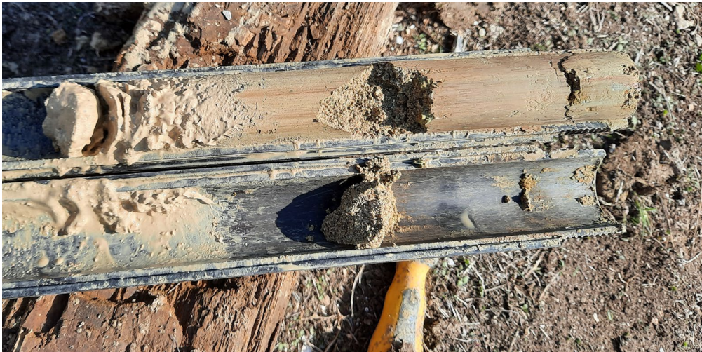
Φωτ. 7.4 Οριζόντας γεώτρησης Γ2 σε βάθος 5.6 - 6.5m με αυξημένη παρουσία αμμώδους κλάσματος που κατατάσσει το υλικό, τοπικά, ως SC ήτοι αργιλώδης Άμμος, μέσης πυκνότητας απόθεσης
