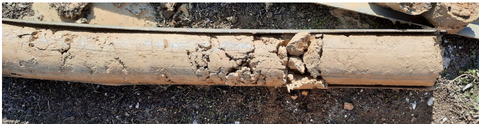
Φωτ. 7.3 Οριζοντας γεώτρησης Γ2 σε βάθος 2.6 - 2.80m με αυξημένο ποσοστό χαλίκων.
