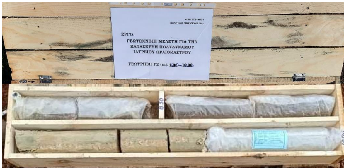
Φωτ. 7: Γεώτρηση Γ2 – Δείγματα Πυρηνοληψίας Εδάφους βάθους 8.0 – 10.00m
